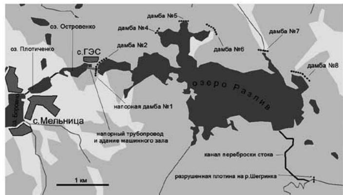
Схема гидротехнических сооружений озера Разлив и Боровно
